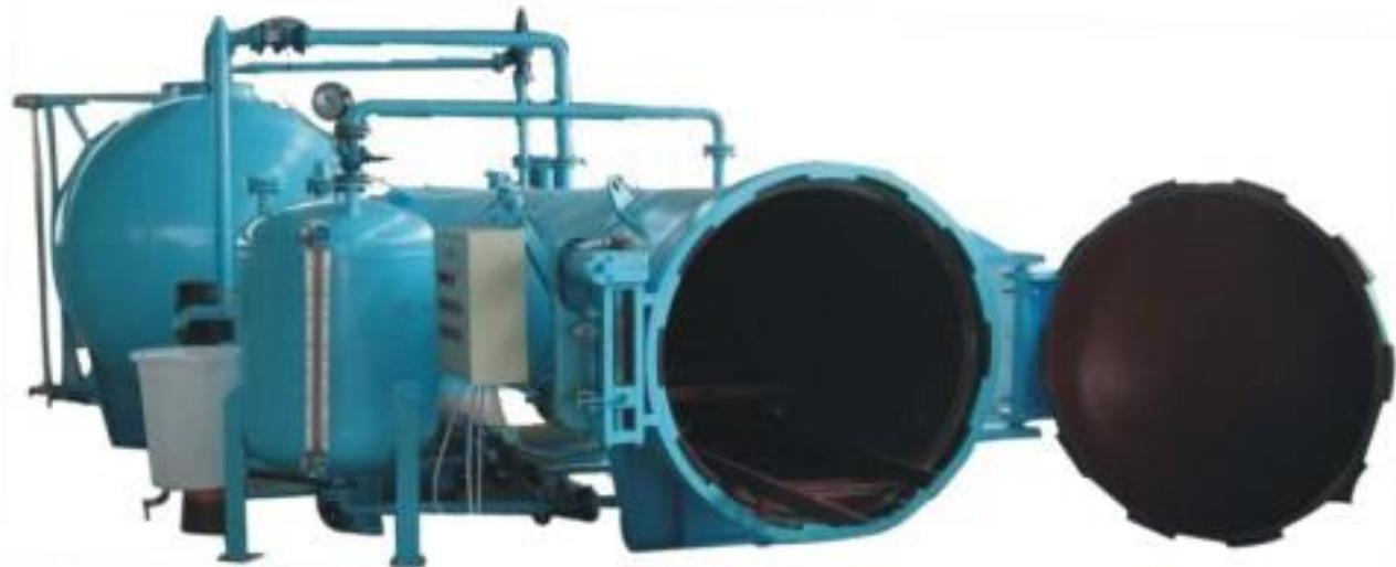
用途: ZM型木材防腐、脱脂、阻燃、染色设备机组是户外园林、景观、别墅以及室内装璜的竹木制品的防腐、防霉、防蛀、防白蚁、阻燃、染色的专用设备。我厂研制的ZM-M型设备几乎能满足所有竹、木材料防腐对设备的要求,同时适用于各种防腐剂、阻燃剂及染料等。性能机组采用真空、加压、加热等一系列工艺操作,并把调制成一定浓度的防腐、阻燃、染色药液经过真空、高压、频压注入木材细胞内部,从而起到防腐、防霉、防蛀、防白蚁及阻燃、染色等效果。该设备目前已经达到国际同类产品的领先水平。
