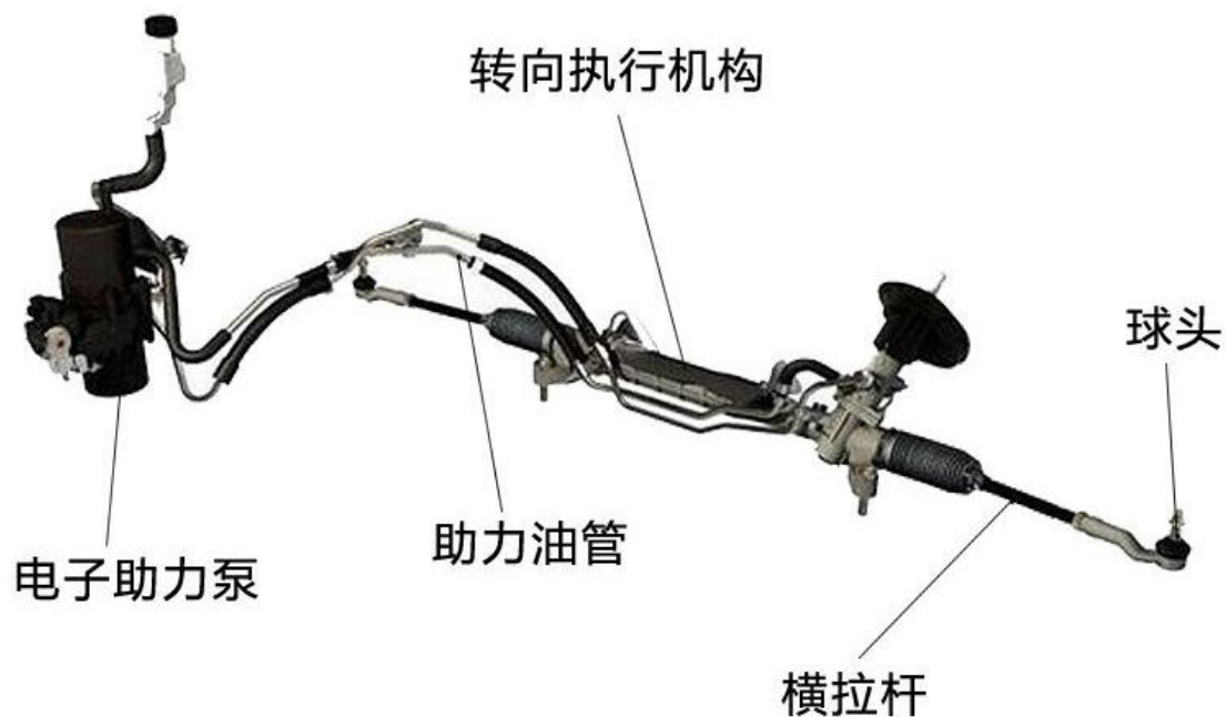
电控液压助力转向系统 ( EHPS )
