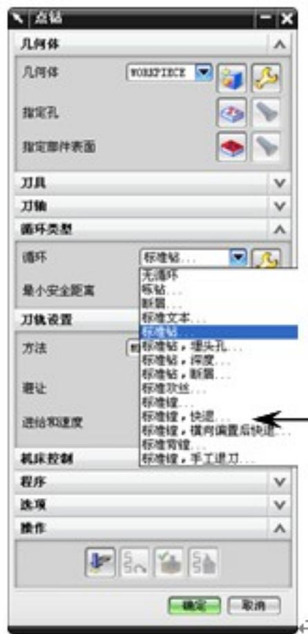
包含 13 种循环类型，和图 7-所示中的 13 个操作子类型相对应。
