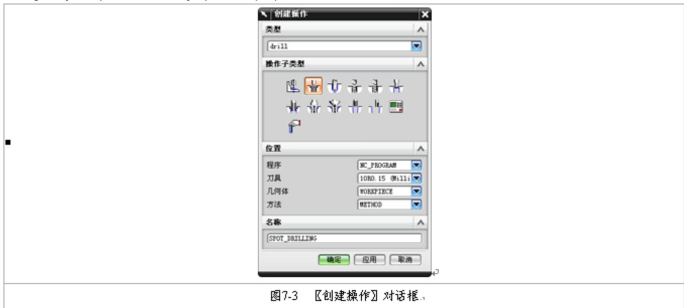
由图 7-所示可以看到钻孔包括 13 种操作子类型, 即 13 种不同的钻孔方法。在【创建操作】对话框中选择“SPOT-DRILLING”操作子类型, 然后单击
