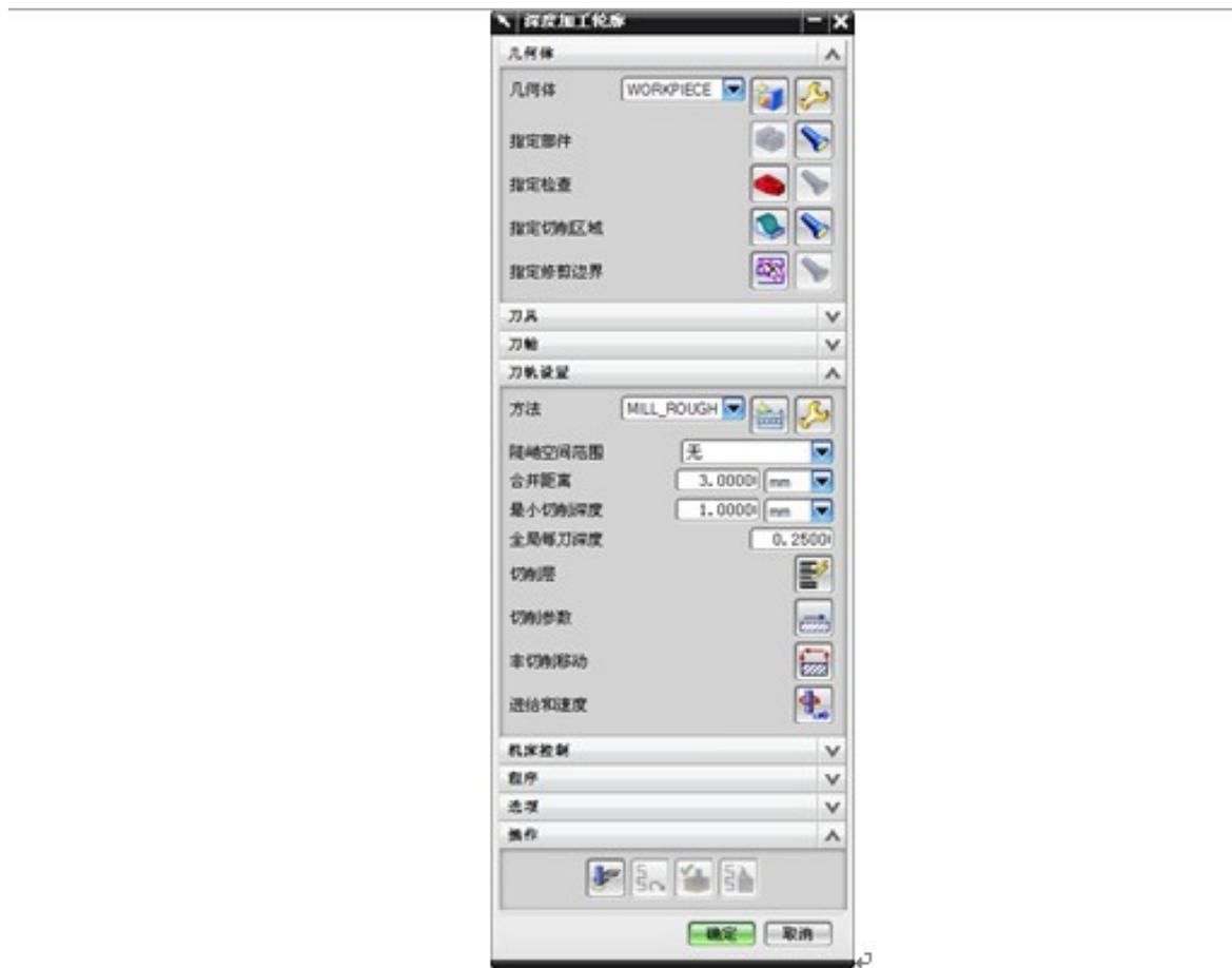
图5-2 【深度加工轮廓】对话框。
